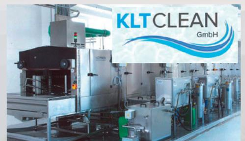
Intensivreinigung: Stark verschmutzte Ladungs-träger werden vor der maschinellen Reinigung einer Intensivreinigung unterzogen. Je nach Verschmutzungsart und -grad werden die Behälter, Kleinladungsträger, Paletten und Trays unter Anwendung spezieller, manueller Reinigungsverfahren gereinigt.
